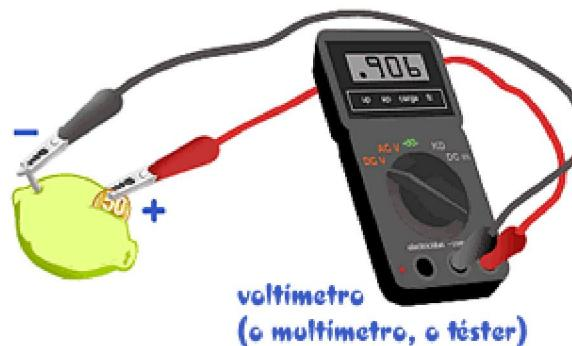
dibujo, el multímetro muestra que nuestra batería está generando un voltaje de 0.906 volts. Lo más importante es que el multímetro nos está diciendo que nuestra batería realmente funciona. Pero como seguramente ya habrás visto, muchos aparatos eléctricos necesitan más de una pila o batería para funcionar.
